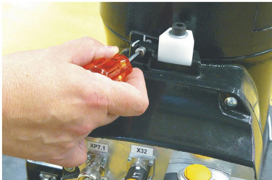
**Abb. 5-17: Schutzkappe der Messpatrone entfernen**
