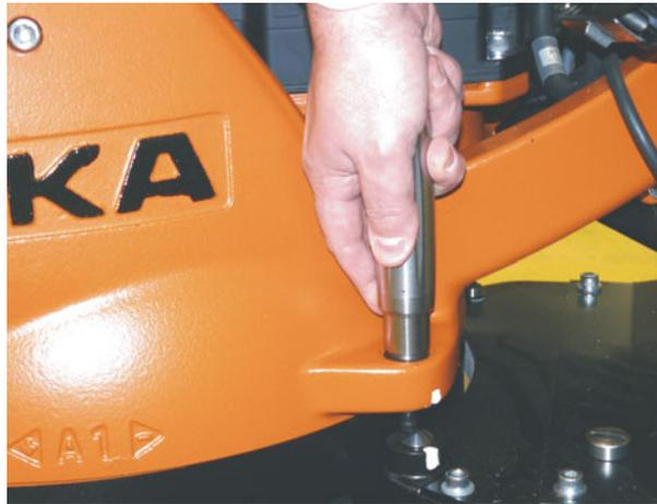
**Abb. 5-10: SEMD auf Messpatrone schrauben**
