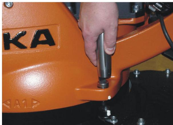
**Abb. 5-9: Schutzkappe der Messpatrone entfernen**
