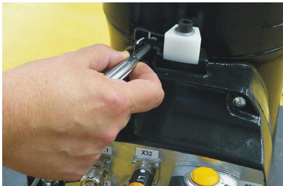
**Abb. 5-18: MEMD auf Messpatrone schrauben**
