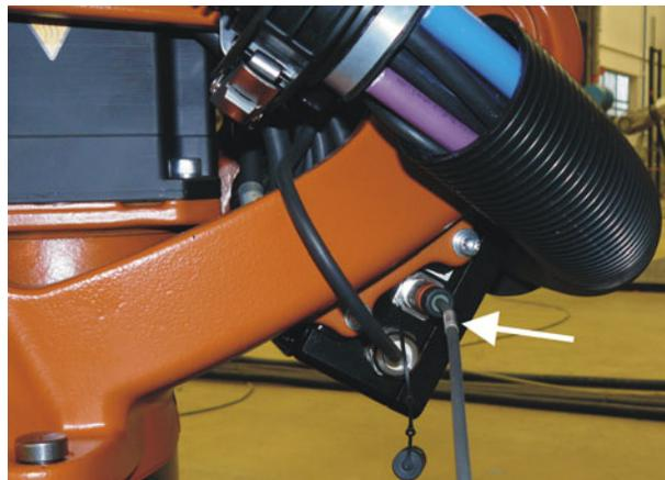
**Abb. 5-8: EtherCAT-Leitung am X32 anschließen**
