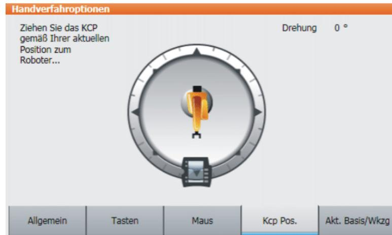
**Abb. 4-23: Ausrichtung der Space Mouse festlegen**
