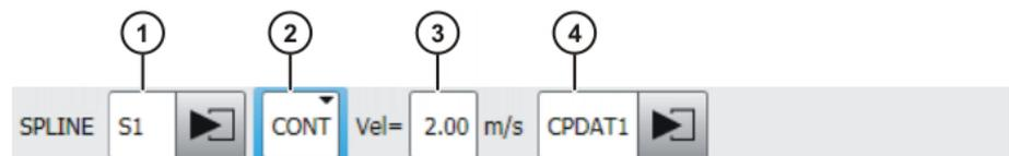
**Abb. 10-8: Inline-Formular CP-Spline-Block**
